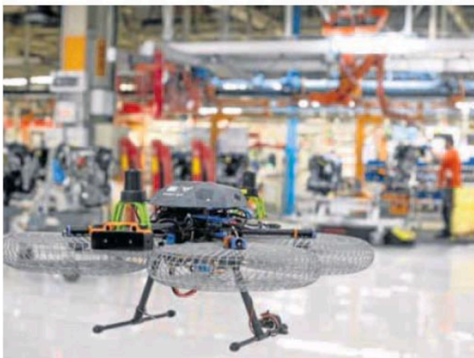
Robot utilizado en la planta de Seat para transportar piezas de forma autónoma. s. c.
